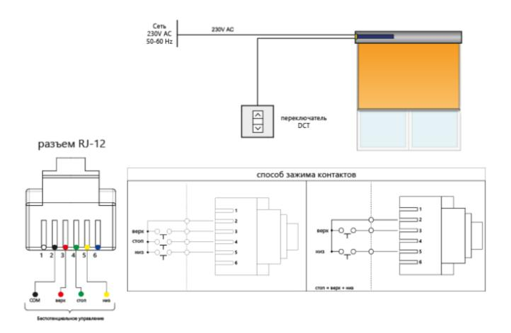
Беспотенциальное управление (сухой контакт) заключается в соединении жил в низковольтном проводе на входе к мотору либо управляющего устройства. Напряжение передается с жилы СОМ на ВЕРХ, НИЗ, СТОП. После соединения СОМ с жилой, отвечающей за направление, либо СТОП, реализуется функция движения/остановки. Функцию остановки можно также достичь, подключив жилу СОМ одновременно с жилами ВЕРХ и НИЗ.
