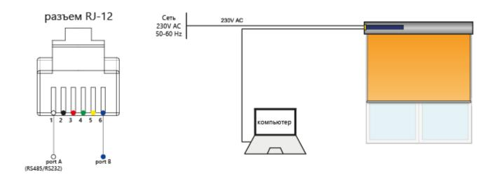
Управление происходит через последовательный порт RS232 или RS485. С помощью коммуникационного протокола данные передаются между приборами. Для управления используются две жилы (разъем RJ12 - жила №1 и №6)
