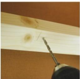
2. Сверлом диаметром 2 мм просверлите отверстия .
