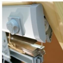
4. Возьмите верхний карниз двумя руками, подвесьте его передней частью на установленное крепление и защелкните его в направлении плоскости окна.
