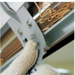
9. Снимите транспортировочные клипсы.
